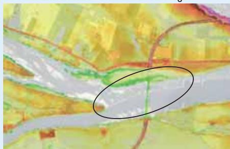
En l'absence d'enrochement, la limite correspond à la droite partant de la pointe de l'île jusqu'au point d'inflexion de la berge opposée.
