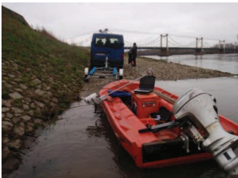
Figure 5 : mise à l'eau du Neveu Secu 12 équipé de l'ADCP River Surveyor M9 de la marque SunTek (photo de Philippe Jugé)
