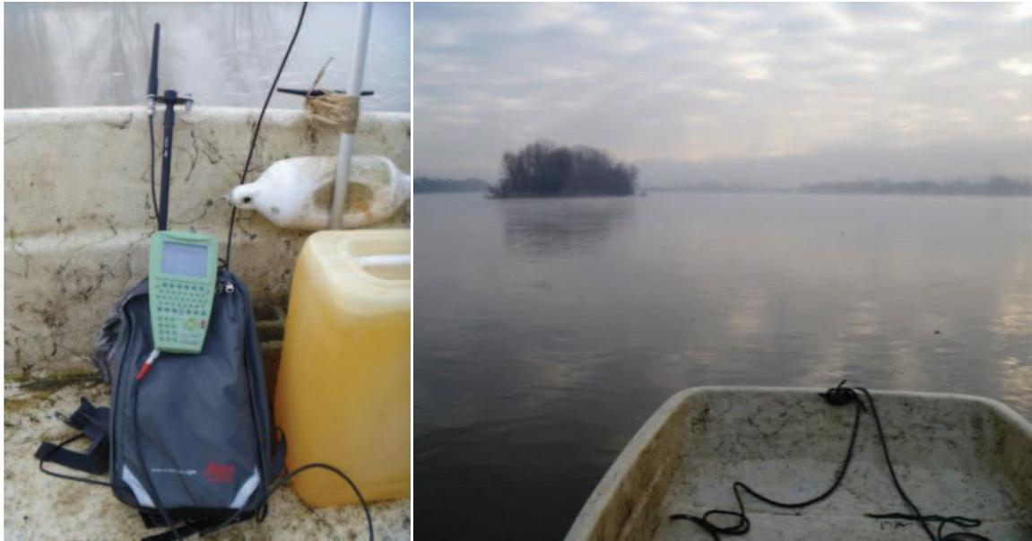
Figure 4 : système GPS Leica GS 1200 équipant le bateau de M. Janin lors de la campagne du 12/01/2012
