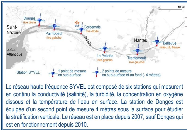
Le réseau haute fréquence SYVEL est composé de six stations qui mesurent en continu la conductivité (salinité), la turbidité, la concentration en oxygène dissous et la température de l'eau en surface. La station de Donges est équipée d'un second point de mesure 4 mètres sous la surface pour étudier la stratification verticale. Le réseau est en place depuis 2007, sauf Donges qui est en fonctionnement depuis 2010.
