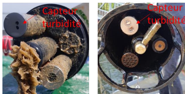
Figure 1 : sonde SAMBAT à gauche et sonde WIMO à droite, avant nettoyage
